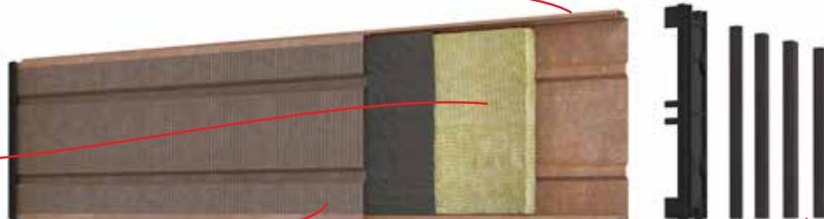
Guscio anteriore forato con percentuale di foratura non inferiore al 35% realizzato in lamiera di acciaio auto passivante CORTEN di spessore 1.0 mm<sup>(1)</sup>
