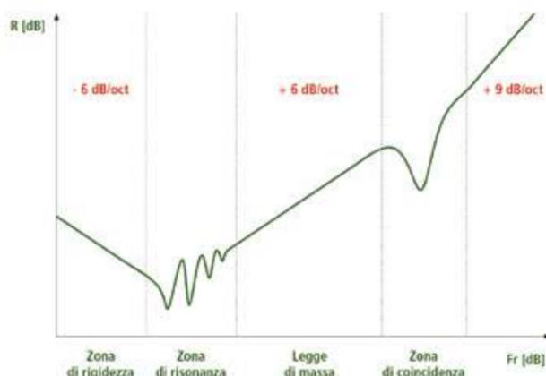
Tabella dell'andamento in frequenza del potere fonoisolante di una parete sottile.
