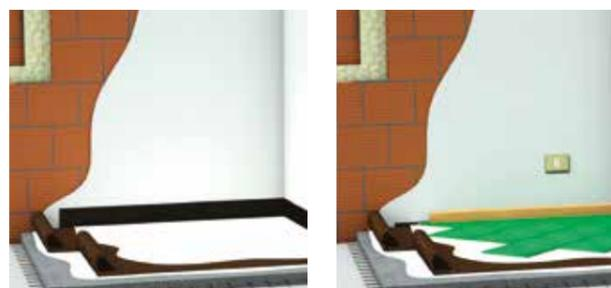
questo tipo di applicazione, e possono essere applicati con finitura a colla o a secco, direttamente sopra al massetto o sopra al pavimento esistente. La finitura a secco è particolarmente indicata per la realizzazione di pavimenti galleggianti con finitura multistrato effetto legno (listoni).
