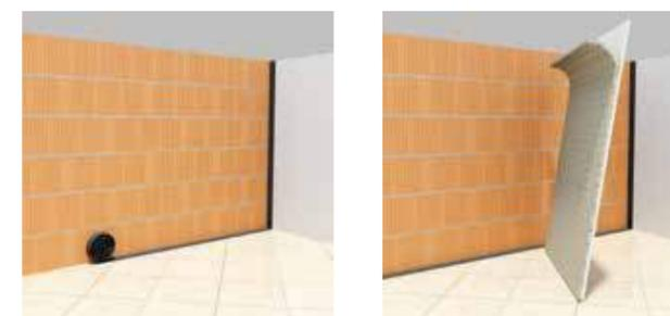
di una speciale membrana polimerica. L'entità del miglioramento dipende sostanzialmente dalla frequenza di risonanza del sistema, dalle caratteristiche del supporto elastico posto nell'intercapedine e dal potere fonoisolante della struttura di base.
