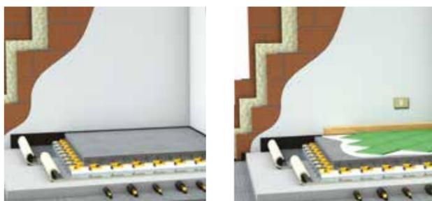
CIRSTRIP lungo tutto il perimetro della pareti. Il massetto galleggiante può essere realizzato anche in presenza di riscaldamento a pavimento, in questo caso il materassino anticalpestio deve essere posato sotto lo strato di isolante termico. Il CIRFONIC Silver è stato studiato appositamente per questo tipo di applicazione, è dotato di una pellicola di polietilene metallizzata termo riflettente che contribuisce a ridurre le dispersioni termiche verso gli strati inferiori del solaio.
