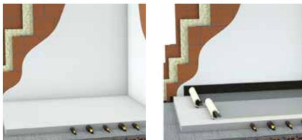
Per il corretto funzionamento del sistema massetto galleggiante è indispensabile desolidarizzare completamente il massetto e il pavimento dalle pareti laterali applicando la striscia perimetrale adesiva
