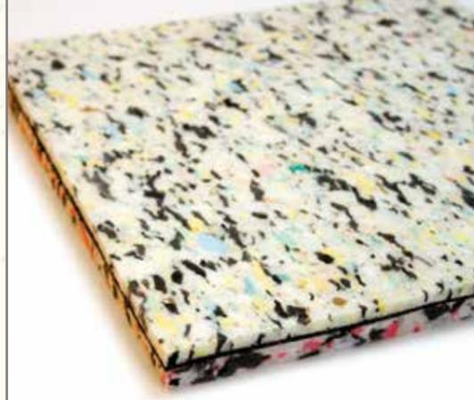
Pannello fonoisolante stratificato in agglomerato poliuretano riciclato espanso flessibile a diversa densità e membrana polimerica.
